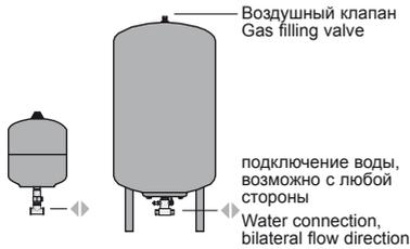
Установка бака может быть необходима со стороны всасывания, с напорной стороны или с обеих сторон повысительной установки. При использовании с напорной стороны необходимо согласовать схему и используемый объём с компетентным предприятием, занимающимся водоснабжением. Следует обратить внимание на ограничение величины и диаметра подключения (см. стр. 4).
